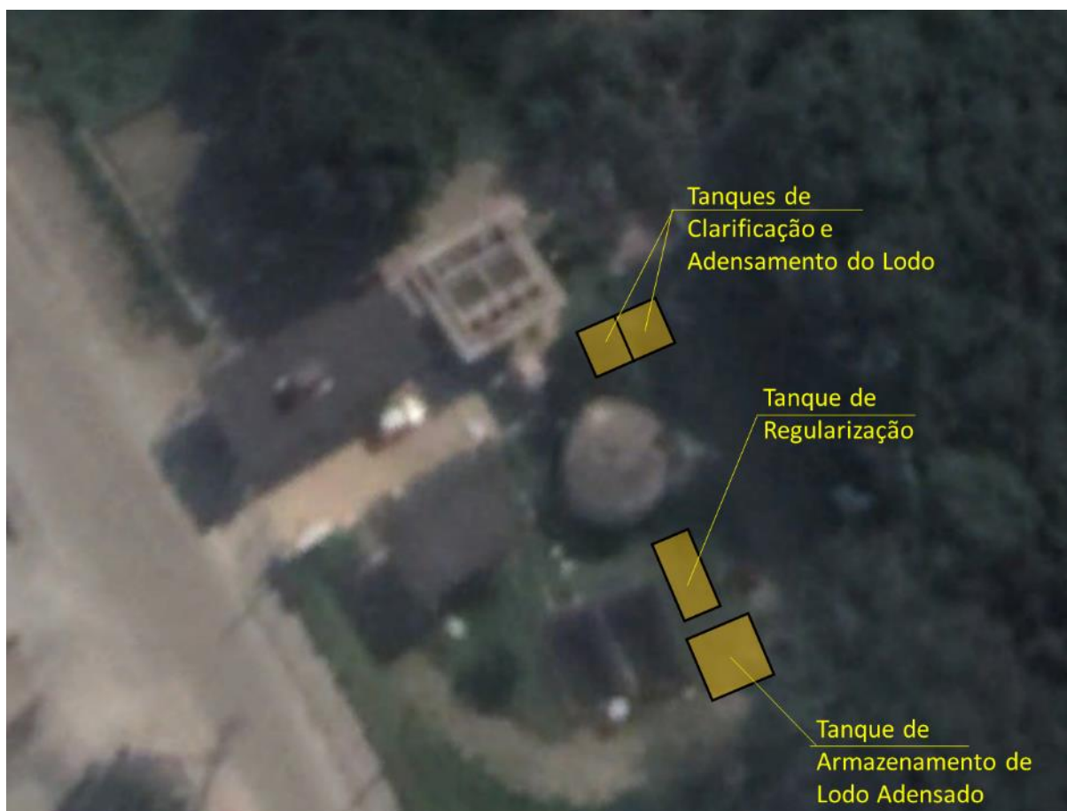
Figura 64 - Layout preliminar proposto para a implantação do sistema de tratamento dos efluentes
