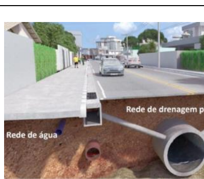
Figura 59 – Sarjetas, bocas de lobo e galerias tubulares
